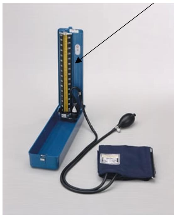
Slika 1: Fotografija tlakomjera za krvni tlak tip DM 300 s prikazom mesta za smještaj ovjerne naljepnice
